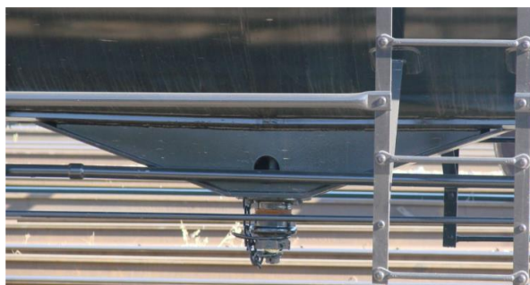
Robinet de vidange par le bas, dispositif ventral de protection—vue externe
