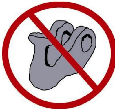
**NOTA :** Pour arrimer sécuritairement un char d'assaut sur un wagon plat, les manilles d'arrimage utilisées doivent être d'une capacité de 21 tonnes (NNO 4030-21-256-2423) Aucun autre dispositif (c.-à-d. : crochet de remorquage tel qu'illustré ci-haut) ne pourra y être substitué.
