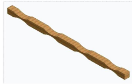
Séparateur en épinette de 6 po sur 6 po découpé pour s'ajuster à la forme du tuyau
