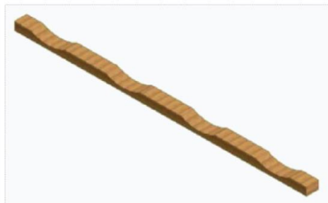
Pièce d'appui en épinette de 4po sur 6 po découpée pour s'ajuster à la forme du tuyau
