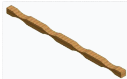
Séparateur en épinette de 2po sur 6po découpé pour s'ajuster à la forme du tuyau
