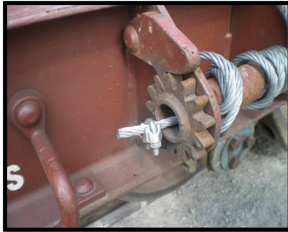
Installation fautive du serre-câble sur le baril du treuil.
