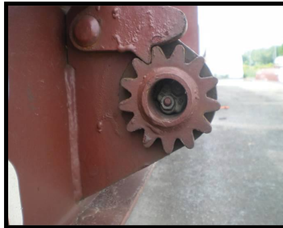
Installation adéquate du serre- câble sur le baril du treuil.
