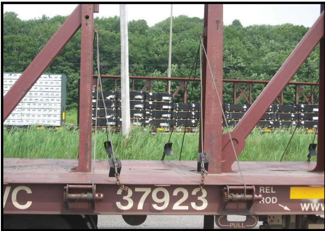
Câbles adéquatement arrimés pour le déplacement du wagon.
