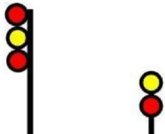
De vitesse moyenne à arrêt – Avancer, vitesse MOYENNE au franchissement du signal et des branchements, être prêt à s'arrêter au signal suivant.
