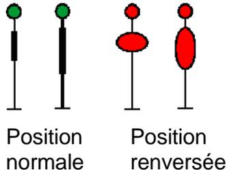
Nota : Les cibles d'aiguillage peuvent avoir une forme différente de celles illustrées ci-dessus, mais ne doivent pas être en forme de losange.
