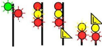
De vitesse limitée à vitesse de marche à vue – Avancer, vitesse LIMITÉE au franchissement du signal et des branchements, le signal suivant est un signal de MARCHE À VUE.
