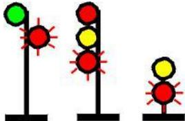
De vitesse moyenne à vitesse de marche à vue – Avancer, vitesse MOYENNE au franchissement du signal et des branchements, le signal suivant est un signal de MARCHE A VUE.
