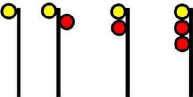
De vitesse normale à arrêt – Avancer, être prêt à s'arrêter au signal suivant.
