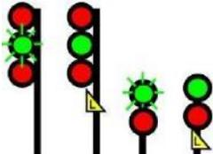
De vitesse limitée à vitesse normale – Avancer, vitesse LIMITÉE au franchissement du signal et des branchements.
