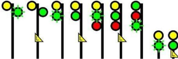
De vitesse normale à vitesse limitée – Avancer, vitesse LIMITÉE à l'approche du signal suivant.
