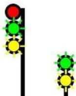
De vitesse limitée à petite vitesse – Avancer, vitesse LIMITÉE au franchissement du signal et des branchements, PETITE vitesse à l'approche du signal suivant.
