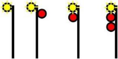
De vitesse normale à arrêt différé – Avancer, être prêt à s'arrêter au second signal.
