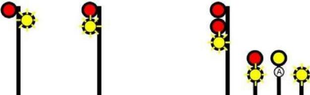
De petite vitesse à arrêt – Avancer, PETITE vitesse au franchissement du signal et des branchements, être prêt à s'arrêter au signal suivant.
