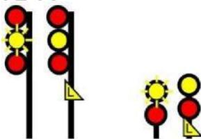
De vitesse limitée à arrêt – Avancer, vitesse LIMITÉE au franchissement du signal et des branchements, être prêt à s'arrêter au signal suivant.
