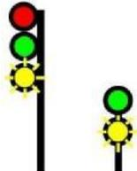
De vitesse moyenne à petite vitesse– Avancer, vitesse MOYENNE au franchissement du signal et des branchements, PETITE vitesse à l'approche du signal suivant.
