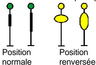
Nota : Les cibles d'aiguillage peuvent avoir une forme différente de celles illustrées ci-dessus, mais ne doivent pas être en forme de losange.
