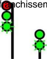
De vitesse moyenne à vitesse limitée – Avancer, vitesse MOYENNE au franchissement du signal et des branchements, vitesse LIMITÉE à l'approche du signal suivant.
