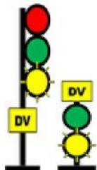
De vitesse moyenne à vitesse de bifurcation - Avancer, vitesse MOYENNE au franchissement du signal et des branchements, vitesse de BIFURCATION à l'approche du signal suivant.
