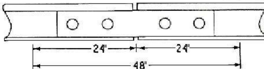
Chaque joint de rail dans les voies de catégories 1 et 2 doit reposer sur au moins une traverse de la qualité prescrite à l'alinéa c) du présent article, dont l'axe longitudinal se situe dans l'intervalle de 48 pouces illustré ci-dessus.
