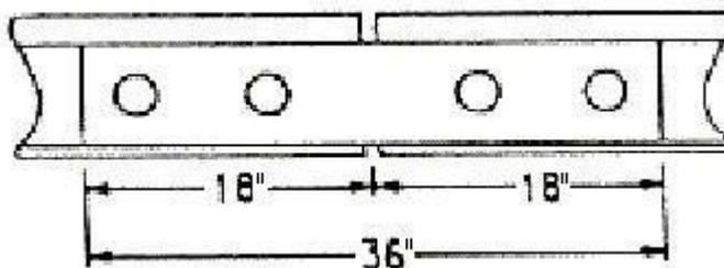
Chaque joint de rail dans les voies des catégories 3 à 5 doit reposer sur au moins une traverse de la qualité prescrite à l'alinéa c) du présent article, dont l'axe longitudinal se situe dans l'intervalle de 36 pouces illustré ci-dessus.
