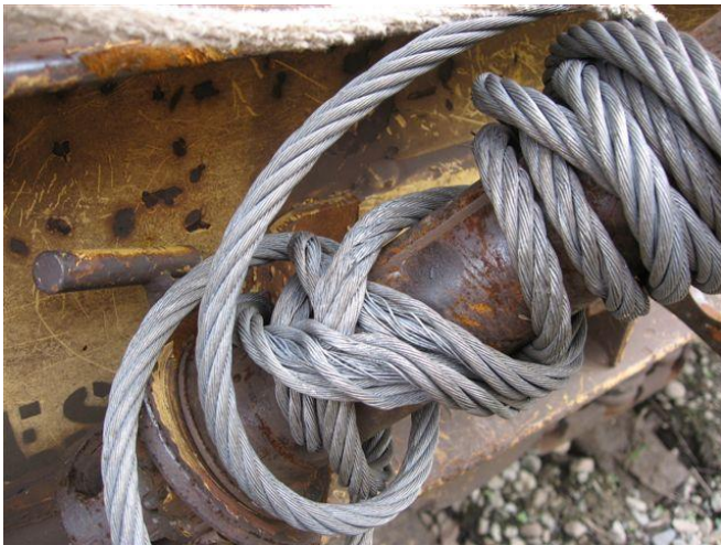
c) Câble avec une section transversale aplatie ou une coque supérieure à 60 degrés.
