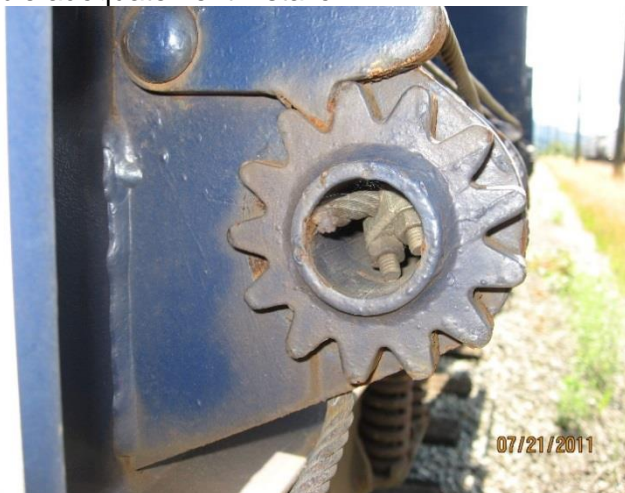
Serre- câble adéquatement installé
