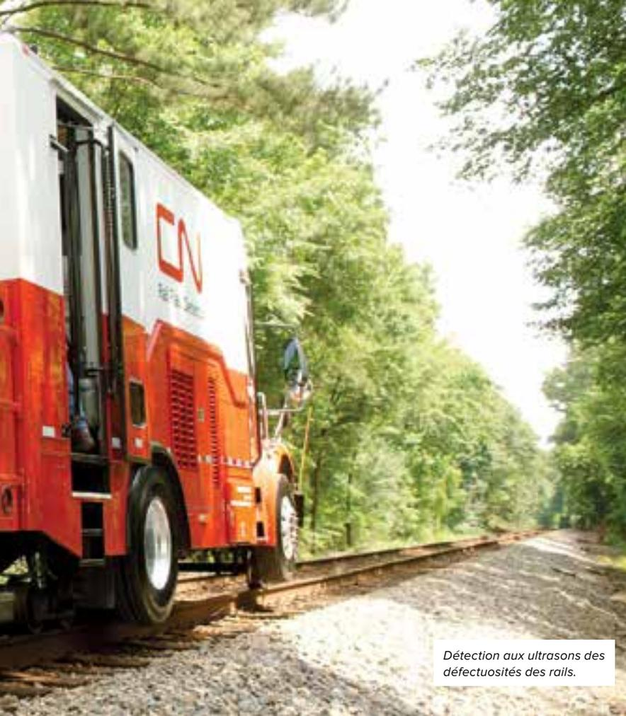
Détection aux ultrasons des défauts des rails.
